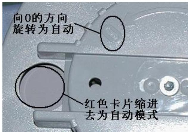
SKD..系列, 手/自动状态 (! 手动状态下, 控制信号将不对执行器有任何作用)
